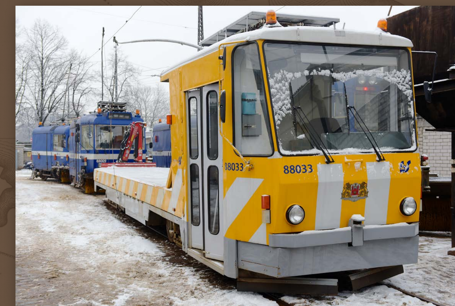
Darba tramvajs ar kravas platformu uz Tatra T-3M bāzes, 2015. gads. Fotogrāfijas autors: Ilmārs Znotiņš
