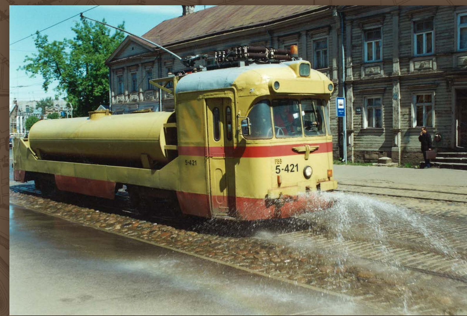
Darba tramvajs sliežu laistīšanai uz RM tipa vagona bāzes. Fotogrāfijas autors: Alberts Pušpurs
