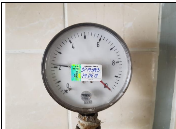
5.4.5.att. Nav veikta mēriekārtu verifikācija atbilstošā termiņā
