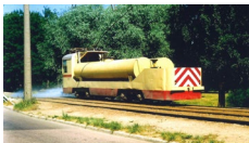
Darba tramvajs sliežu laistīšanai uz BM tipa vagona bāzes, 1994. gads. Fotogrāfijas autors: Igors Klučņevs
