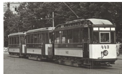
Pastkarte, jaunā parauga tramvajs ar plūdinājas formas jumtu un iekārtas Elektrotehniskās fabrikas (EKF) motoriem un elektroskārdēm - trīs vagonu tramvaja sastāvs kāpaka buvdarī pie Krīģļa Valdemāra ielas, 1936. gadu otrā pusē. Fotografējis autors nav zināms.
