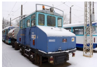
Darba tramvajs sliežu slipētājam, 2015. gada 26. janvārī. Fotogrāfijas autors: Imāns Znotiņš
