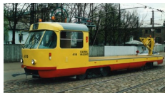
Darba tramvajs ar kravas platformu, veidots uz Tatra T-1 tramvaja bāzes, 2001. gads. Fotogrāfijas autors: Alberts Pulgurs
