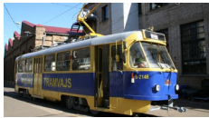
Mācību tramvajs Nr.5-2146, izveidots kuzībai gan ar pantogrāfu, gan kontaktstabi, testētajā brīdī tas ir līdz 191. 2008. gada 24. augusts. Fotogrāfijas autors: Alberts Puļpurs
