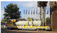
Darba tramvajs sliežu laistīšanai, izbūvēts uz Tatra T-3M tramvaja bāzes, 2014. gada 6. septembrī. Fotogrāfijas autors: Marats Aulija
