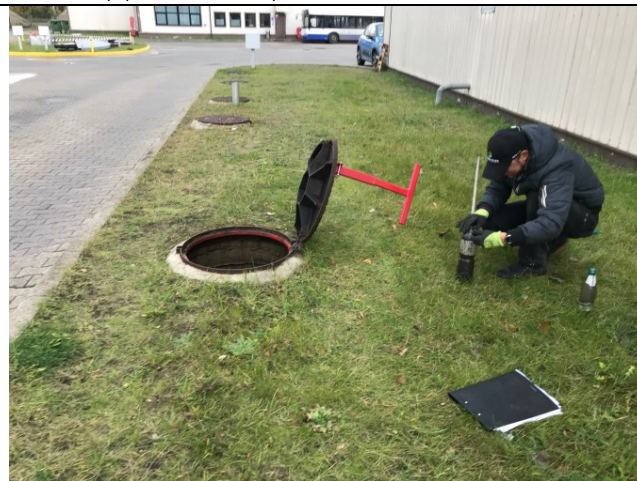
9. Foto. Ražošanas notekūdens parauga Nr. RS/KL-NŪ-RN-3IE noņemšana no skatakas Nr. RK-15 pirms ieplūšanas autobusu mazgātavas priekšattīrīšanas iekārtās Bioekol-vrt-10AM (23.10.2020.)
