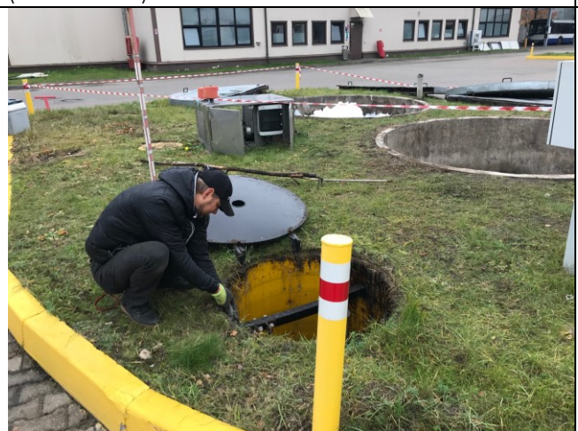
13. Foto. Lietus notekūdens parauga Nr. RS/KL-NŪ-LN-4B noņemšana pirms suspendēto vielu un naftas produktu attīrītāja ESK-10 jeb skatakas Nr. LK-18 (29.10.2020.)
