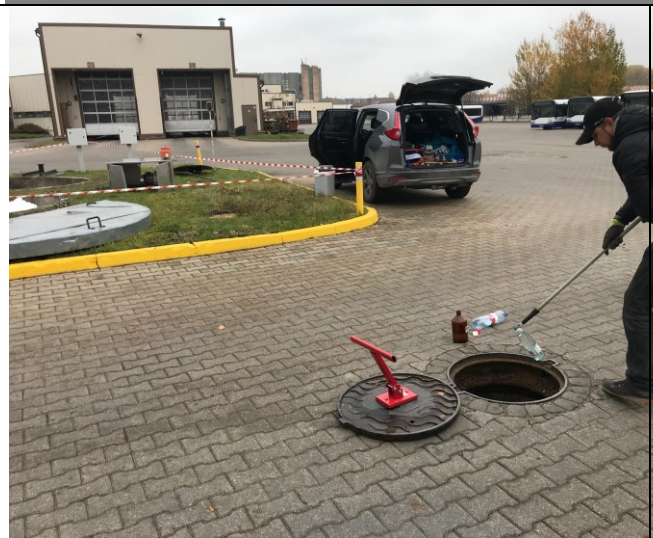
11. Foto. Lietus notekūdens parauga Nr. RS/KL-NŪ-LN-4A noņemšana pēc suspendēto vielu un naftas produktu attīrītāja ESK-10 jeb skatakas Nr. RK-7 (29.10.2020.)
