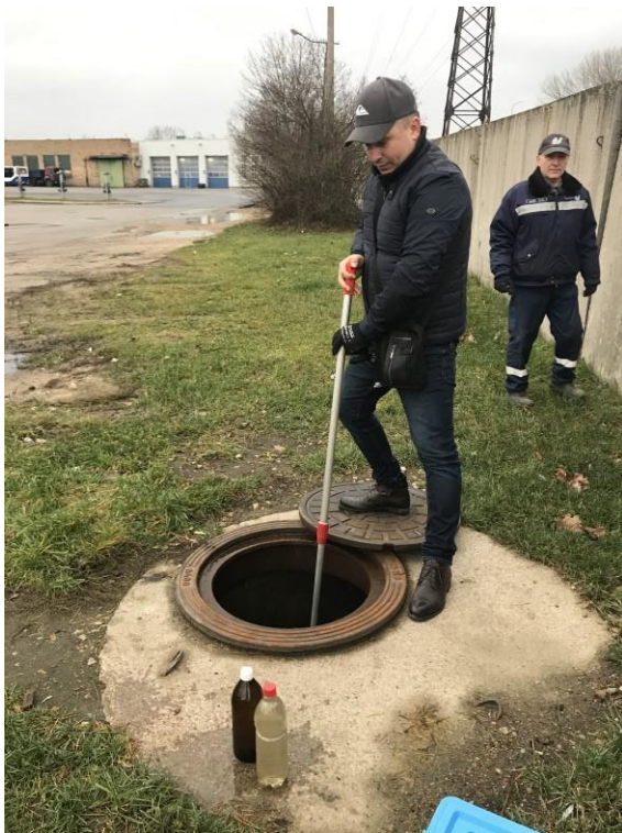
7. Foto. Notekūdens vizuālais skats lietus kanalizācijas skatakā Nr. LK-1 (pieslēguma punktā Nr. 1) parauga noņemšanas brīdī (14.11.2019.)
