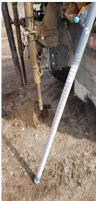
2.1. attēls. PVC filtrkolonna ar filtrmateriālu
